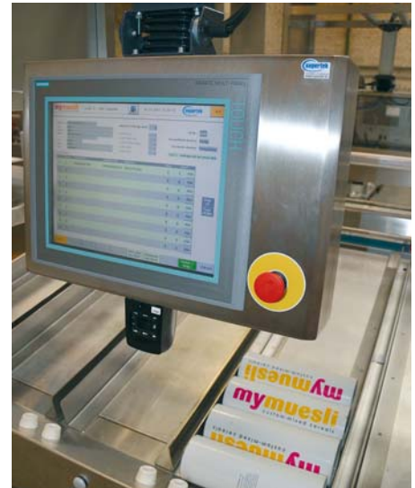
Die Bediener bei Mymuesli überwachen alle Abfüllprozesse komfortabel über ein Touch Panel, das eventuelle Störungen schnell anzeigt.
