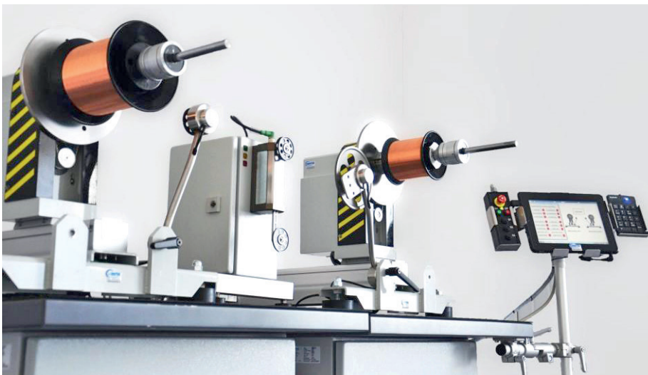
Umspulanlage der „MW“- Klasse mit traversierenden Verlegern und elektromagnetischem Tänzer für präzises Wickeln etwa von Draht, Flachdraht, Faser, Lichtwellenleiter, Folie oder Lot. Bilder: Supertek
